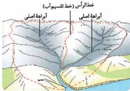
این شکل، یک حوضه آبخیز را با دو انشعاب یا آبراهه اصلی نشان می‌دهد. خط مقطع، مرز این دو حوضه را تعیین می‌کند. مرز حوضه در واقع خطالرأس یا خط تقسیم آب بین حوضه‌هایی است که مجاور هم قرار گرفته‌اند.
